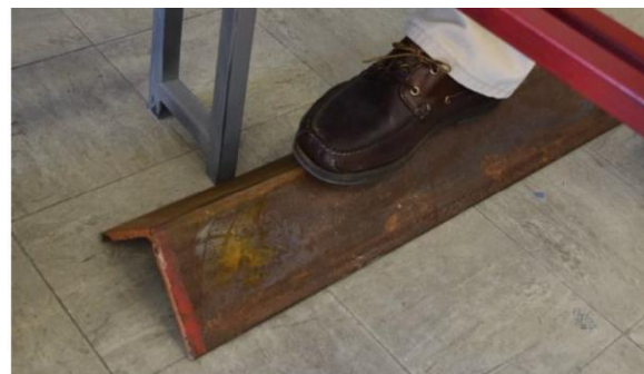
Exemples de retenue latérale : maintenu par la pression du pied (gauche), à partir d'un profilé métallique en contact avec l'appui du pont (droite)
