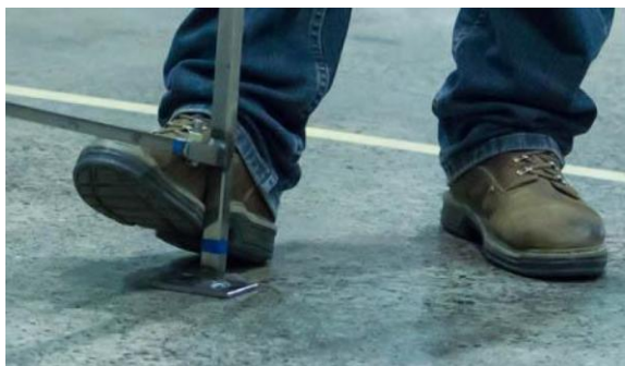
Exemples de retenue latérale : maintenu par la pression du pied (gauche), à partir d'un profilé métallique en contact avec l'appui du pont (droite)
