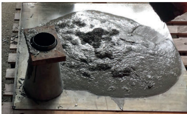
Abb. 7: Konsistenzprüfung der 1. Mischung mit klaren Anzeichen von Entmischung (Faserklumpen), welche zu Fehlstellen führte
