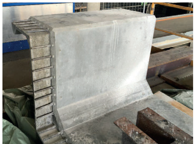
Abb. 10: Randbord des Musterelements mit optimierter UHFB-Mischung
