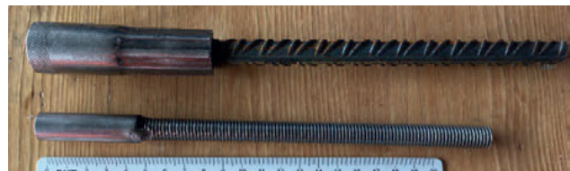
Abb. 20: Geprüfte Einlagen zur Geländerbefestigung, Muffe M14 mit Bewehrungsstab Ø12 mm (oben), Muffe M12 mit Gewindestab M12 (unten)
