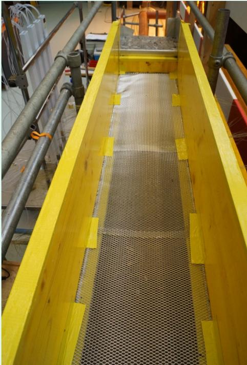
Affouillement et distribution irrégulière des petits débits – proposition d'un système de distribution de l'eau: tuyau PVC à fentes coupé longitudinalement avec canal perforé pour la distribution des débits faibles
