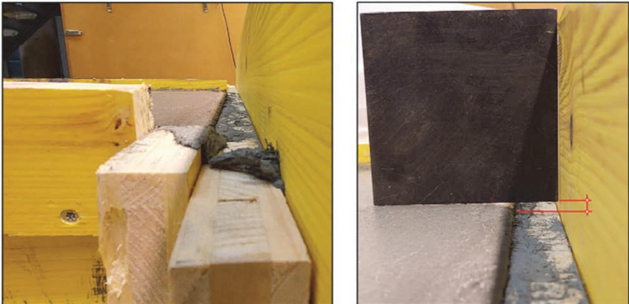
Abb. 4: Nachverflüssigung des UHFB – Test von HEIA-FR
