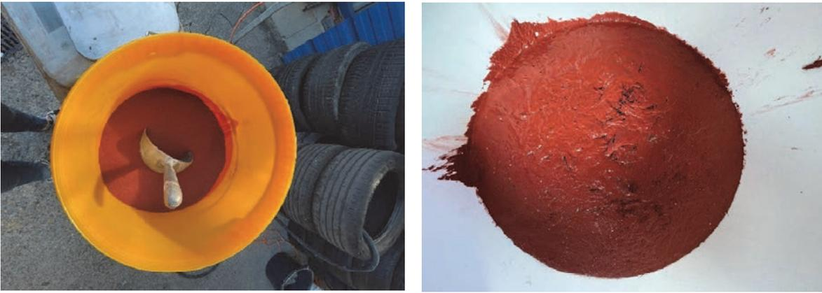
*Fig. 9 : Essais de pigmentation du CFUP*
