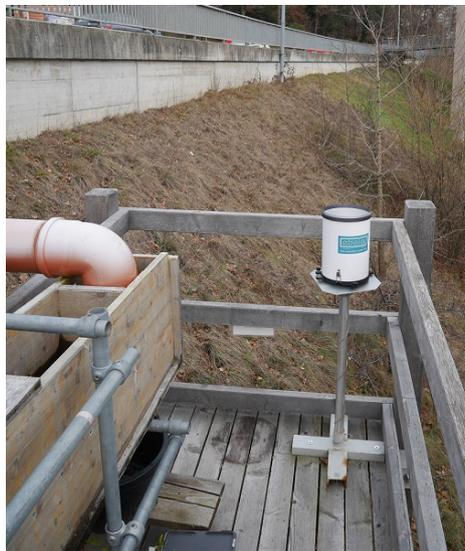
Figure 6-1 : Pluviomètre installé sur le site du banc d'essai.
