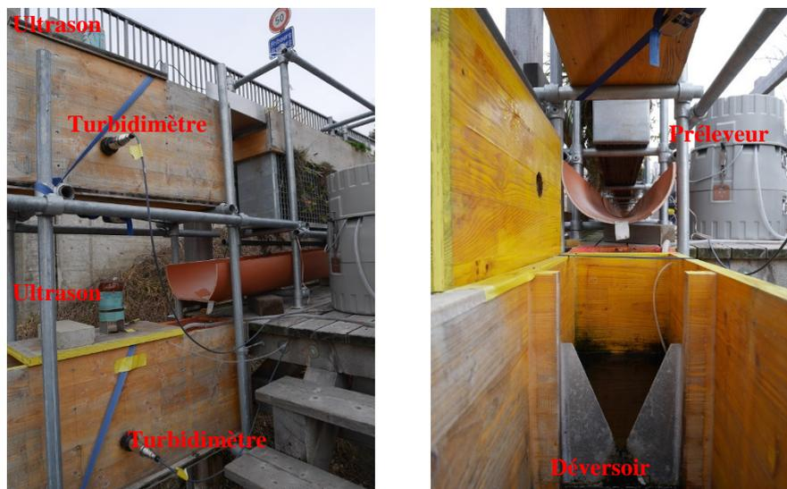
Figure 6-3 : Bacs de sortie avec le déversoir et les différents instruments de mesures installés.
