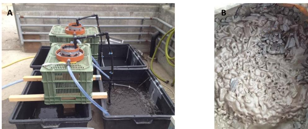
Figure 4 : A : Dispositif expérimental de traçage et de transfert des polluants de chaussée – B : Colmatage en surface à l'issue des expériences de transfert des polluants de chaussée.
