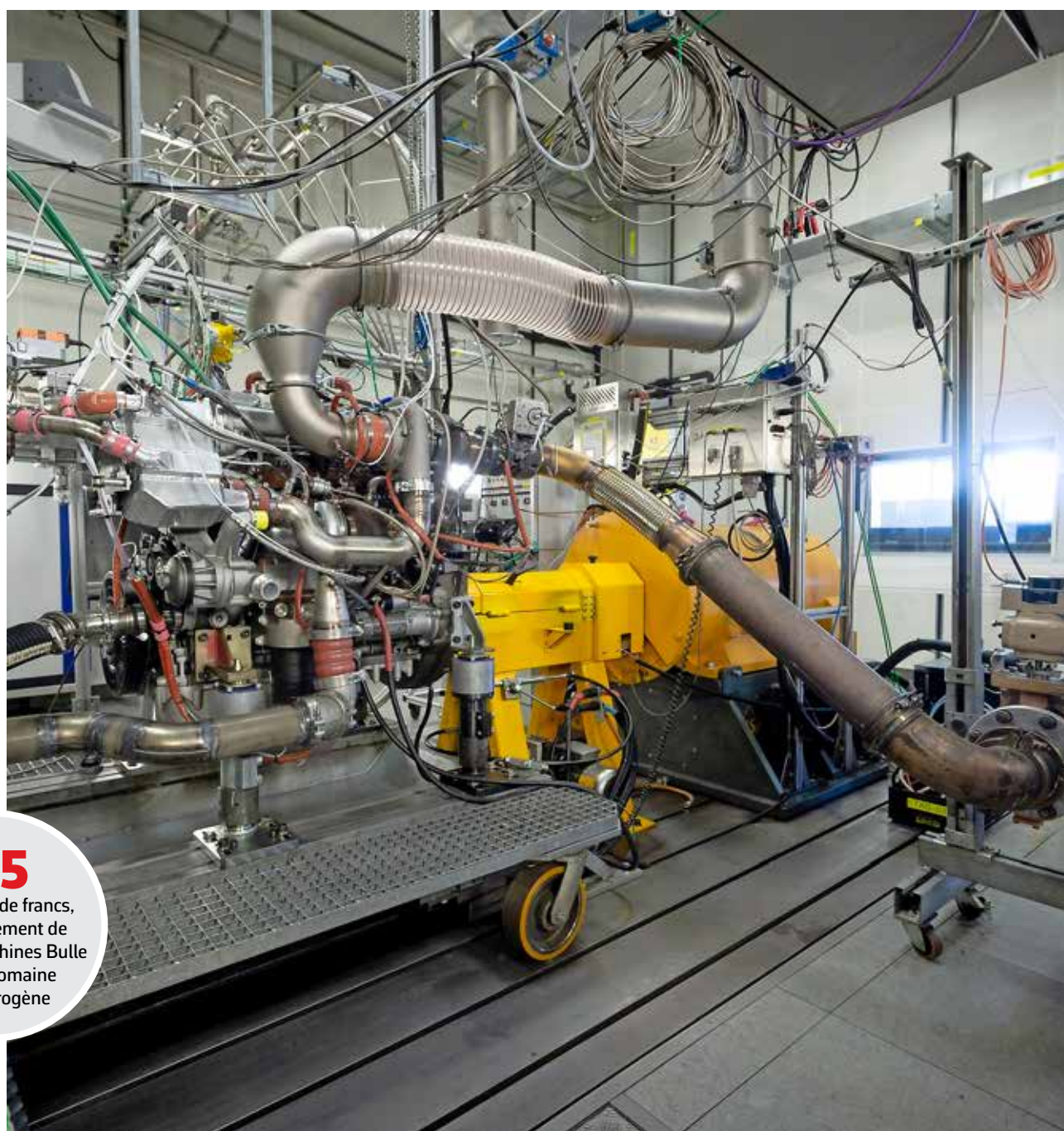
Liebherr Machines Bulle a investi dans de nouveaux bancs d'essais pour tester les moteurs à hydrogène. Charly Rappo
